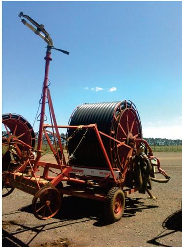
**Figura 17.4** Autopropelido ou carretel, próprio para irrigação de faixas largas, em Vacaria, RS.
